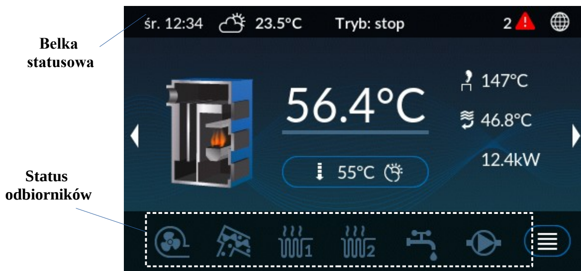
Ilustracja 11: Ekran główny, ekran kotła C.O.
