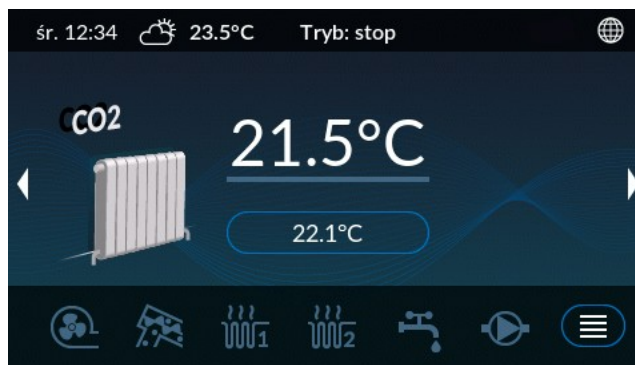
Ilustracja 15: Ekran obwodu CO.2
